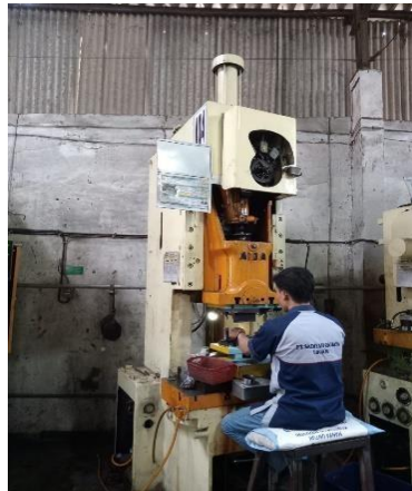
Gambar 3 Proses Pengerjaan Stamping
