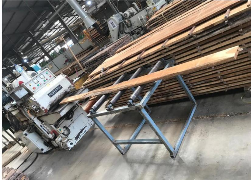
**Gambar 4. Bentuk Meja roller dan tumpukan kayu/pallet yang meringankan operator mesin memasukkan kayu ke mesin.**
