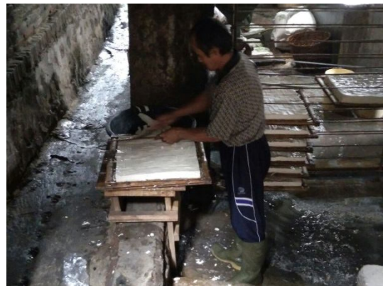
Gambar 2. Pemotongan Tahu Besar Secara Manual
