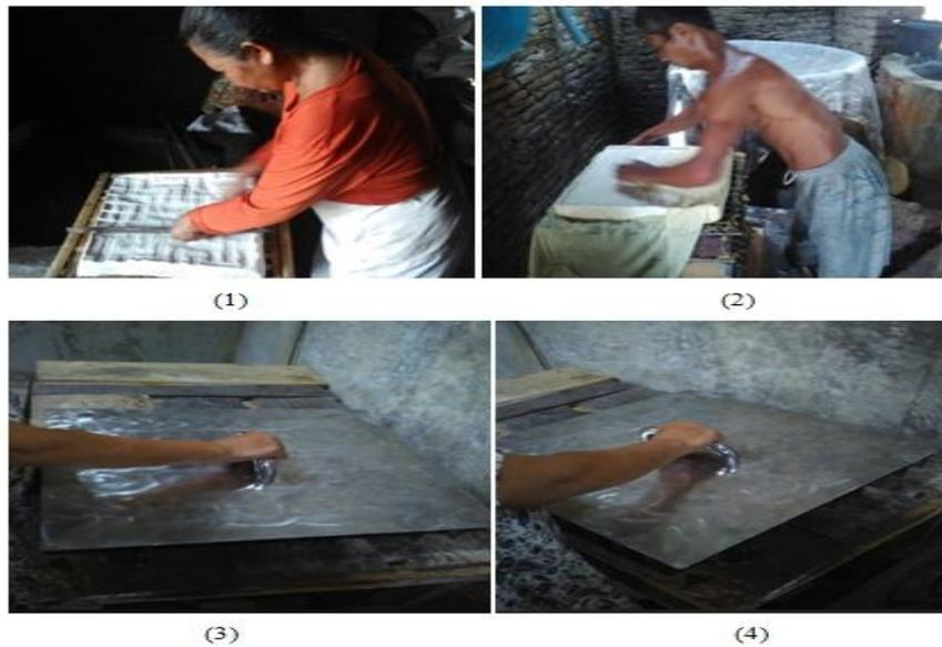
**Gambar 9.** perbedaan cara memotong versi lama manual (1) (2) dan cara memotong menggunakan dengan alat yang dirancang (3) (4)
