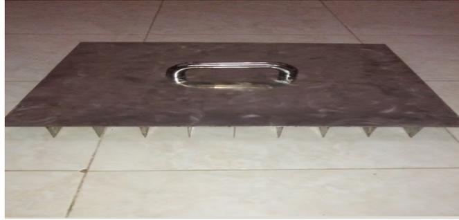
**Gambar 8.** Gambar Hasil Rancangan Alat Pemotong Tahu
